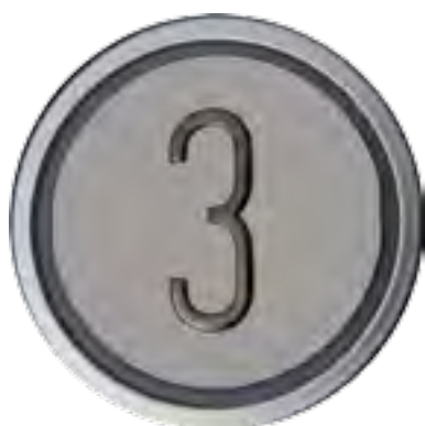
Taster B50 R – matt, Tasterplatte Edelstahl mattiert, Rahmen P – matt, Ziffer taktil, ohne / alternativ mit Braille-Schrift, Rufquittungsring, Ø 58 mm
